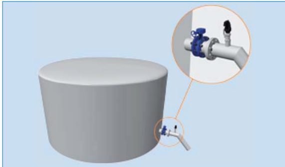
Salida de reservorio, aguas abajo de la válvula de corte
